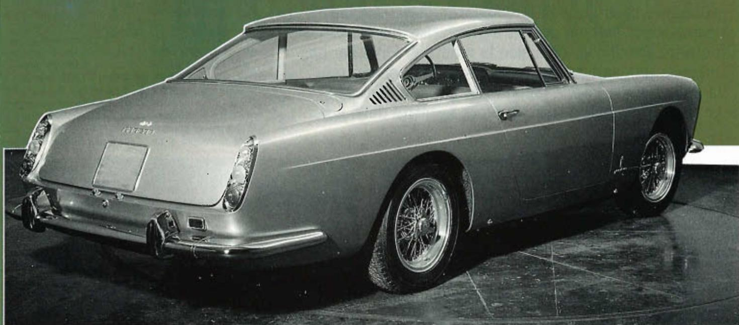
Nella foto in alto, il primo prototipo della Ferrari 250 GTE 2+2. Si notino le feritoie di ventilazione sui montanti posteriori. Qui sotto, una vista frontale della stessa vettura, caratterizzata dalle ghiere dei fari cromate, che in seguito furono eliminate.
